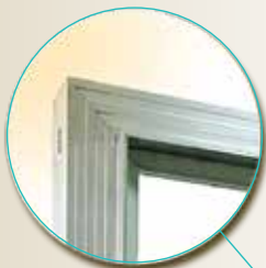
Механически сборная конструкция, собрана при помощи ввинчивания винтов в прочный алюминиевый уголок толщиной 8 мм
