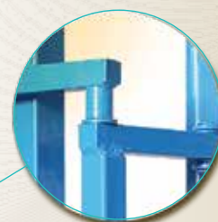
Жёсткая стальная петля не имеющая люфта, изготовлена из стального квадратного прутка. Максимальная нагрузка - 16 кг.
